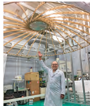
小型SAR衛星の金メッキメッシュパラボラアンテナ
