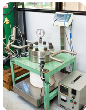
シリカエアロゲルの製作に使う超臨界乾燥装置。炭酸の超臨界相を利用する
