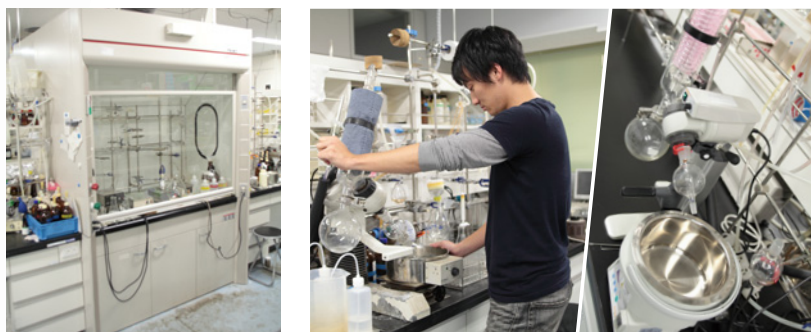
左 濱田教授が日本薬学会賞を受賞した論文が掲載された、日本薬学会の会誌 中 実験では様々な条件下での合成を行うため、有害な気体を用いることもある。写真は、安全に排気を行うための装置「ドラフトチャンバー」 右 溶媒の除去を行い必要とする化合物を取り出すための装置「ロータリーエバポレーター」と、実際にそれを使用する学生の様子
